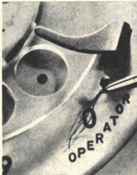
Il minuscolo microfono realizzato dalla Raytheon è dotato di una sensibilità compresa fra 0,01 e 120.000 cicli al secondo.
