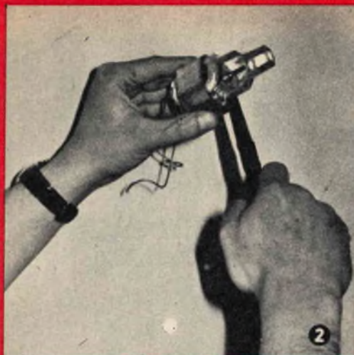
La prima operazione da fare consiste nell'avvitare alla carcassa del motore il ponticello metallico.
