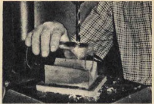
Fig. 2 - Le operazioni di trapanatura del tubo di plastica si effettuano appoggiando il tubo stesso su un blocco di legno opportunamente sagomato e fissato al banco di lavoro.
