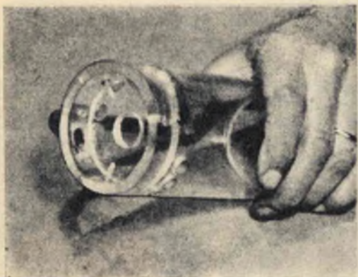
Fig. 5 - La camera pompante è ottenuta mediante l'applicazione di un disco di plastica. E' visibile, a lato, il tubo d'uscita leggermente inclinato.
