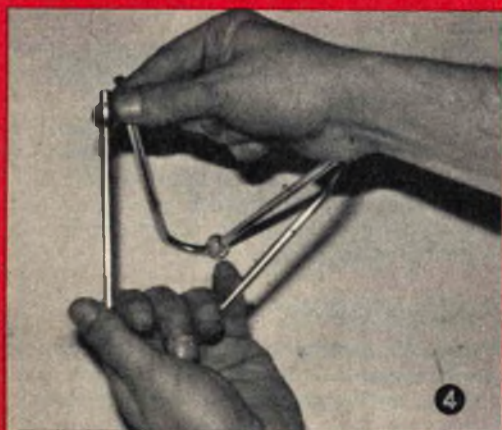
Il piedistallo si prepara introducendo una ad una le tre palline di plastica che costituiscono i piedini di appoggio.
