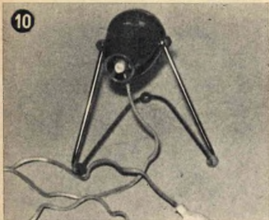
L'unico punto di fissaggio del motore alla calotta è costituito dall'anellino di chiusura dell'interruttore a pulsante.
