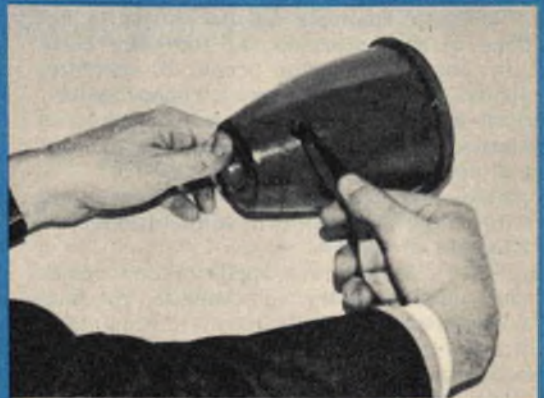
Fig. 3 - L'introduzione del gommino passante nell'apposito foro ricavato nella calotta posteriore dell'elettrodomestico sarà facilitata dall'uso delle pinze, come si vede nella foto.
