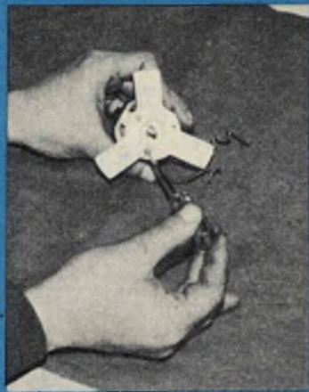
Fig. 6 - La piastrina metallica, di forma circolare, applicata sulla testa del motorino elettrico, è dotata di tre fori filettati: su questi tre fori vengono avvitate le tre viti che fissano la crociera.
