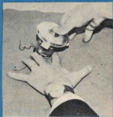
Fig. 8 - Il lavoro di montaggio di tutte le parti contenute nella calotta posteriore si completa applicando il cordone di alimentazione ai fili elettrici uscenti dal motorino.
