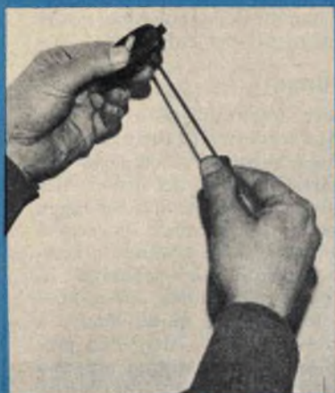
Fig. 4 - L'interruttore si apre facilmente mediante un semplice cacciavite. Basterà estrarre le due viti di fissaggio per separare le due parti che lo compongono.
