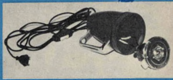
Fig. 8 - Il lavoro di montaggio di tutte le parti contenute nella calotta posteriore si completa applicando il cordone di alimentazione ai fili elettrici uscenti dal motorino.
