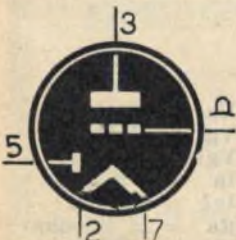
1 H5 TRIODO-DIODO AMPLIFICATORE- RIVELATORE (zoccolo octal)
