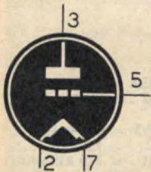
1 H4 TRIODO AMPLIFICATORE (zoccolo octal)
