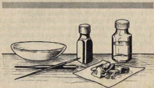
Fig. 1 - Un pennellino o una penna, un piatto da cucina, l'inchiostro, l'acido e il diluente sono gli elementi necessari per incidere con il primo metodo.
