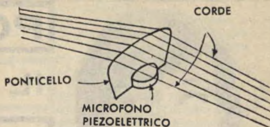
Fig. 8 - Il microfono piezoelettrico costituisce il più semplice tipo di captatore; esso va inserito nell'interno della chitarra, sotto il ponticello, come indicato in figura.
