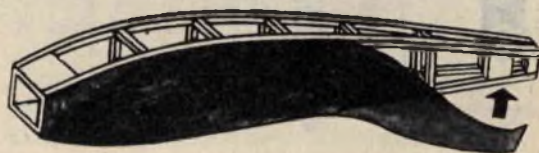
Fig. 12 - La copertura per zone va effettuata nei modelli di grandi dimensioni o, comunque, in quei modelli la cui fusoliera non abbia tutte le sezioni quadrangolari.
