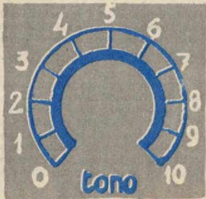
Fig. 4 - Il procedimento di incisione dell'alluminio si rende assai utile per comporre piccoli quadranti o scale numeriche da applicare su pannelli di apparati elettrici.
