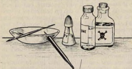
Fig. 2 - Per il secondo metodo di incisione occorre il comune acido muriatico oltre all'inchiostro e al pulitore.
