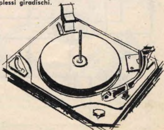
Fig. 2 - L'amplificatore stereofonico richiede un pick-up speciale a due avvolgimenti. In commercio sono attualmente reperibili gli appositi complessi giradischi.
