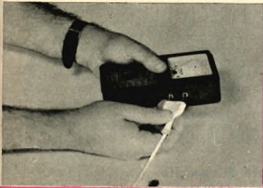
Fig. 5 L'alimentazione dello strumento con la corrente alternata della rete-luce si fa quando si debbano effettuare misure di alti valori resistivi, di capacità e di frequenze.
