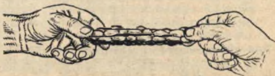
Fig. 10 - In questa forma allotropica lo zolfo si presenta come una massa pastosa ed elastica, simile alla gomma da masticare.
