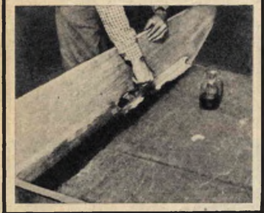
SOPRA: Il barchino può essere trasportato sul posto con una auto. SOTTO: Una fase della calafatazione. A DESTRA: L'applicazione del fondo.
