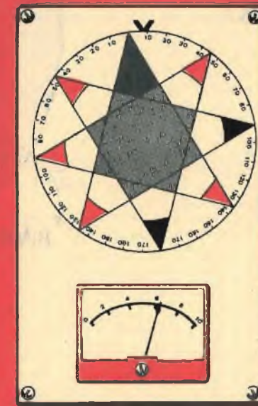
Fig. 7 - La lettura dei gradi, riportati lungo la circonferenza del disco, si effettua in corrispondenza della piccola freccia applicata alla cassetta contenitrice del circuito amplificatore.
