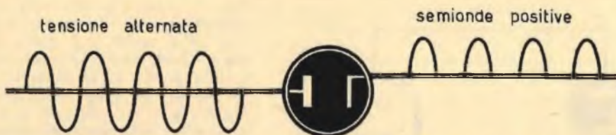
Fig. 9 - Il diodo a vuoto spinto può essere utilizzato per raddrizzare le correnti alternate e per presiedere al processo di rivelazione dei segnali radio. Attraverso il diodo passano le semionde di uno stesso nome, in modo che dal catodo è possibile prelevare una corrente formata da sole semionde positive.
