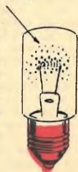
Fig. 2 - Anche i filamenti delle comuni lampade per illuminazione risultano avvolti da una invisibile nube di elettroni, la cui fuoriuscita dal metallo che compone il filamento è provocata dalla elevata temperatura di quest'ultimo.
