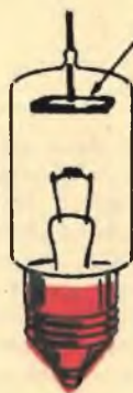
Fig. 3 - Una comune lampadina può divenire un diodo se in essa viene inserita una placchetta metallica fornita di un conduttore comunicante con l'esterno.
