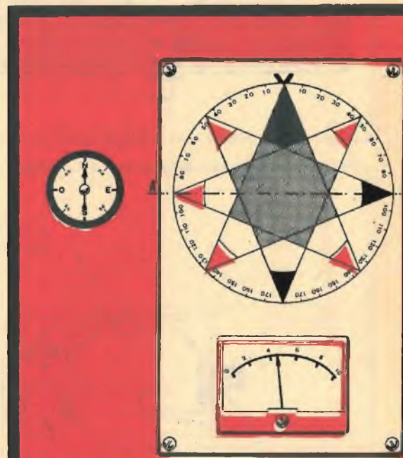
Fig. 5 - L'uso del radiogoniometro, così come è stato descritto nel testo, impone un preciso orientamento dalla cassetta ottenuto con l'aiuto di una semplice bussola.
