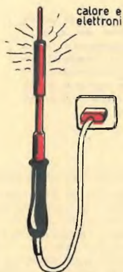
Fig. 1 - La punta di un saldatore, finché è calda, risulta avvolta da una invisibile nube di elettroni, cioè di cariche elettriche negative. Si tratta di un fenomeno comune a tutti i metalli elevati ad un certo valore di temperatura.
