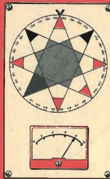
Fig. 6 - La costruzione del disco rotante deve rispondere a precise esigenze meccaniche; ma la composizione del disco, cioè del disegno su di esso riportato, è arbitraria.
