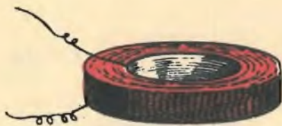
Fig. 10 - Questo è l'aspetto esteriore di una bobina a nido d'api, attualmente presente in tutti i ricevitori radio, in funzione di bobina di accordo e bobina di avvolgimento di trasformatore di media frequenza.
