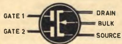
Fig. 3 - Simbolo elettrico di un transistor MOS dotato di due entrate (gate 1 - gate 2).
