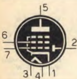
12CR7 DIODO-PENTODO RIV. AMPL. BF (zoccolo noval)
