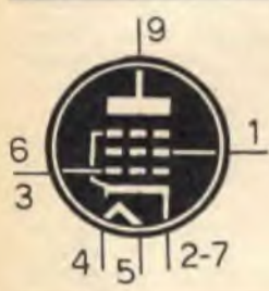
12CS5 PENTODO FINALE BF (zoccolo noval)
