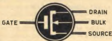
Fig. 2 - Simbolo elettrico di un transistor MOS ad effetto di campo con una sola entrata (gate).
