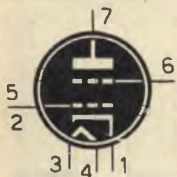
12C5 TETRODO FINALE BF (zoccolo miniatura)
