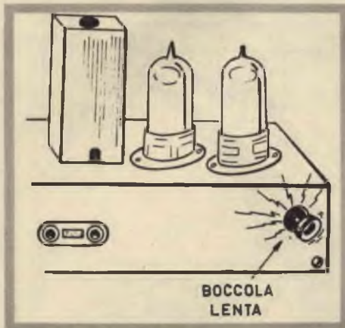
Fig. 1 - La bobina d'antenna può essere fonte continua di scricchiolii; il fenomeno si manifesta quando essa non è ben fissata al telaio, oppure quando è ossidata.
