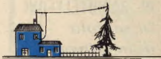
Fig. 8 - L'antenna più efficiente, per il rivelatore a diodo di germanio, è quella di tipo Marconi, della lunghezza di 20-25 metri circa.
