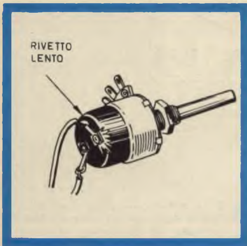
Fig. 4 - Normalmente i terminali degli interruttori, connessi con i potenziometri, sono fissati per mezzo di rivetti. L'allentamento di un rivetto può essere causa di scricchiolii.
