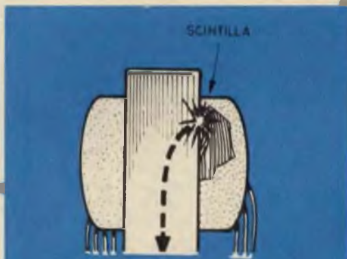
Fig. 14 - I trasformatori possono essere fonte di crepitii. Ciò si verifica quando ha inizio un processo di cortocircuito tra gli avvolgimenti e la massa. L'inconveniente può essere rivelato con l'ohmmetro.
