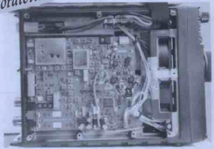
Detrás de sus blindajes, estas son las caras que ofrece el FT-897 en su interior. En la imagen de la derecha se aprecian los dos ventiladores encargados de mantener la temperatura al nivel idóneo.
