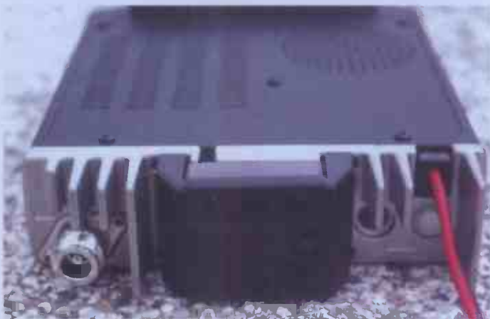
Parte posterior del 707 con detalle del ventilador.
