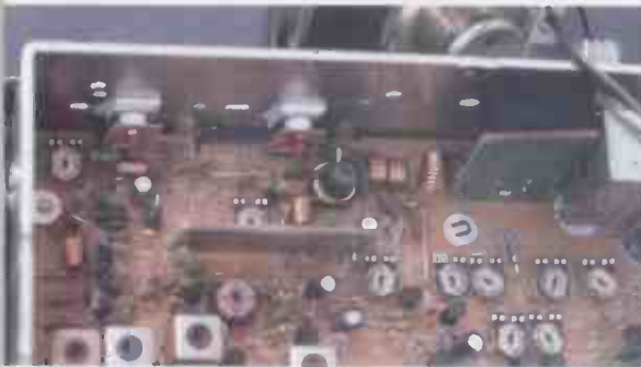
Transistor de salida del la Super Jopix 1000 (2SC 1969).
