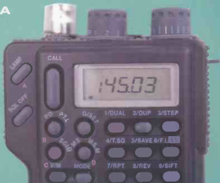
Frecuencímetro y parte del teclado del C-150, el primer transmisor de VHF de SHC. El diseño de este portátil es muy clásico.
