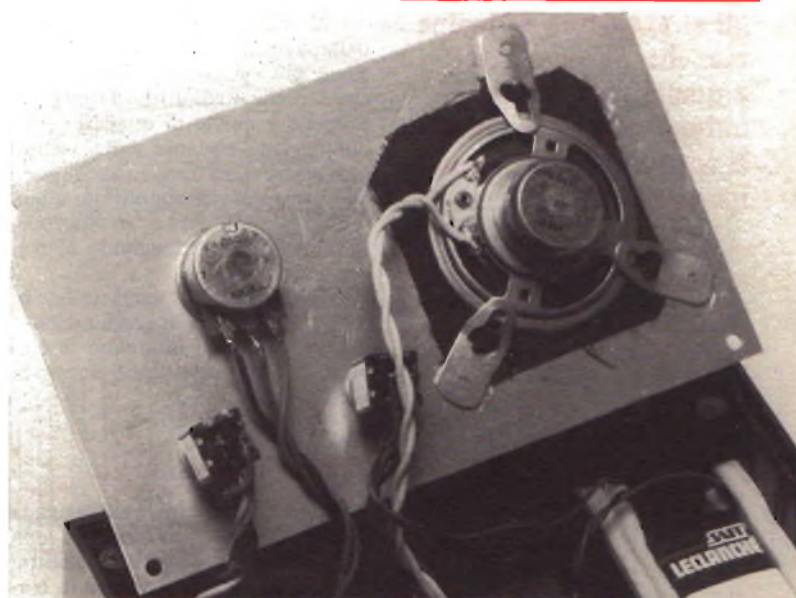
Foto 3. Mezzo pratico di fissaggio dell'altoparlante sul pannello anteriore.
