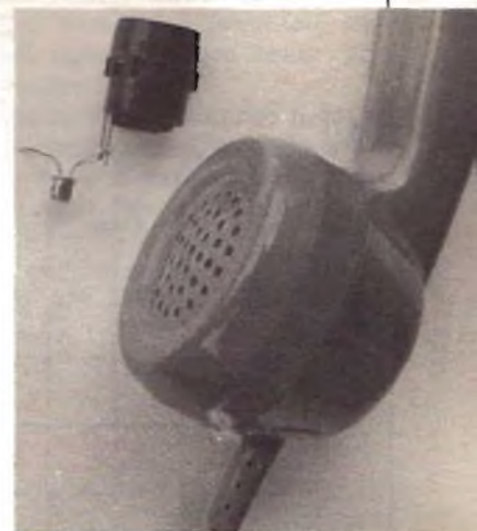
Foto 2. Questi preamplificatori permettono di sostituire direttamente i microfoni a carbone con eccellenti pastiglie dinamiche o piezoelettriche.
