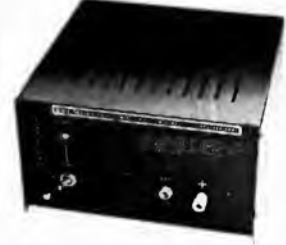
BRS 35 alimentatore stabilizzato 13,8 Vc.c. - 10 A Stabilità 0.2% - Ripple 1 mV
