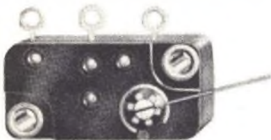
In alto, basetta ad allestimento ultimato. A lato, particolare di un microswitch che può essere utilizzato per questo progetto. Sotto: particolare in cui si evidenzia l'interruttore di comando realizzato artigianalmente.
