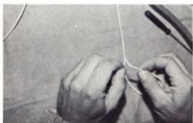
Si attorciglia la spirale facendone un unico conduttore con un certo angolo dal conduttore interno.
