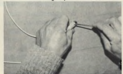
Porre la linguetta metallica in modo che la spina risulti rigidamente collegata a cavo.
