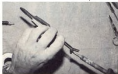
Preparazione di una spina a pin jack con il cavo di connessione.
