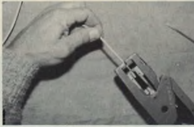
Si toglie una parte dell'isolante esterno con l'apposito attrezzo.
