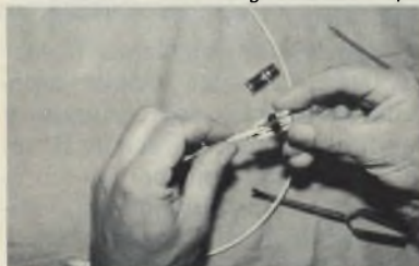
La punta del saldatore deve naturalmente essere ben pulita e lo stagno di ottima qualità.
