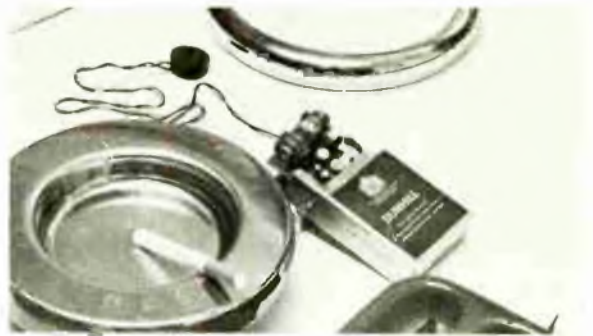
Il corpo dell'intera microemittente spia può essere raccolto in un piccolo contenitore; un pacchetto rigido per le sigarette si presta perfettamente
