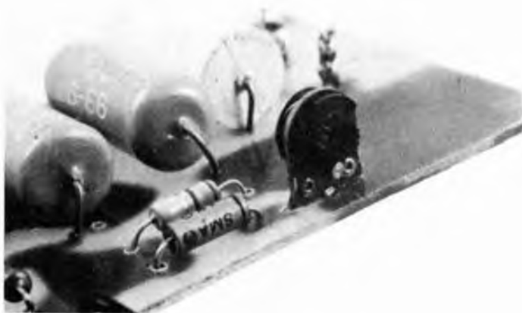
Particolare circuitale. Il piccolo trimmer può essere sostituito da un potenziometro consentendo una facile regolazione esterna.
