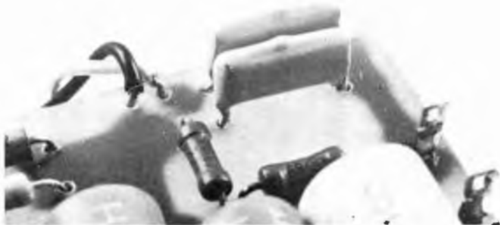
I due condensatori (in alto sulla bassetta) vengono inseriti e disattivati con il deviatore cambiando il punto di lavoro del filtro.
