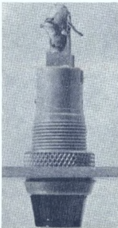
Particolare dell'indicatore luminoso utilizzato per i nostri esperimenti. Il costruttore potrà sostituirlo con uno adeguato alle proprie necessità, ad esempio con indicatori luminosi analoghi a quelli utilizzati su diversi modelli di motoveicoli.
