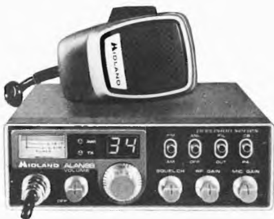
RICETRASMETTITORE MIDLAND ALAN mod. 34 34 canali AM omologato PT per uso industriale utilizzato per i punti: 2, 3, 3, 3, 4, 4
