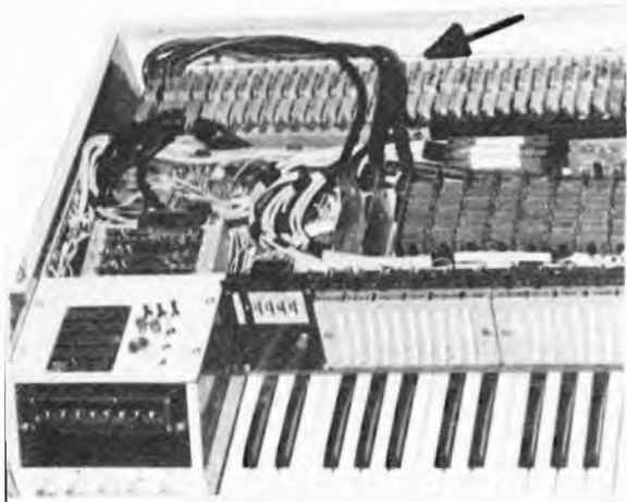
Foto 7 - Schede I/U 1-2-3-4 già cablate verso l'esterno.
