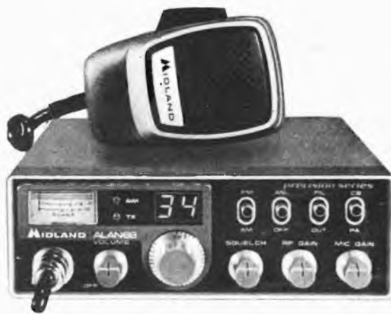
RICETRASMETTITORE MIDLAND ALAN mod. 68 34+34 canali (68) AM-FH omologato PT per uso industriale utilizzato per i punti: 7, 7, 1, 1, 2
