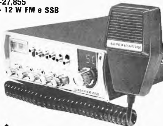
RICETRASMETTITORE SUPERSTAR 2000 2000 canali AM-FM-USB-LSB Frequenze 25,965-28,005 MHz.
