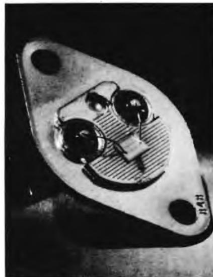
Figura 3 - Caratteristiche realizzative interne di un transistor Motorola del tipo TMOS, privo del cappuccio di protezione.
