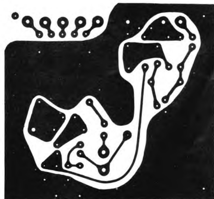
Figura 2 - Lato rame del circuito stampato a grandezza naturale: attraverso la figura 3 è facile identificare la posizione dei diversi componenti sul lato opposto.
