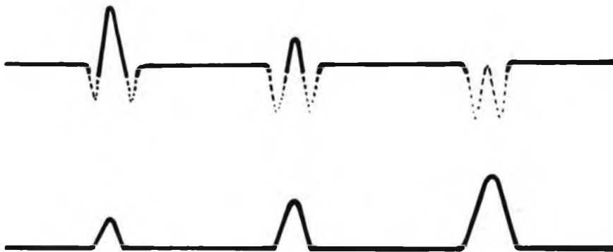
Figura 5 - Come respingere i tappi d'acciaio: mettere l'interruttore Discriminate nella posizione «Screw Caps» e aumentare la velocità di passaggio della bobina sul terreno.
