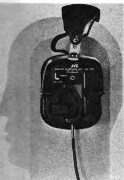
Figura 4 - Fotografia di un modello di « testa finta », sulla quale è stato installato il dispositivo HM200E, contenente la combinazione tra cuffie e microfoni, con caratteristiche molto simili a quelle dell'orecchio umano.
