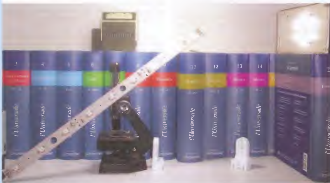
Fig.20 In questa fotografia sono visibili in alto a destra la lampada di emergenza e in basso, da sinistra, la barra luminosa a 9 diodi led e i due supporti plastici utilizzati per il suo bloccaggio.
