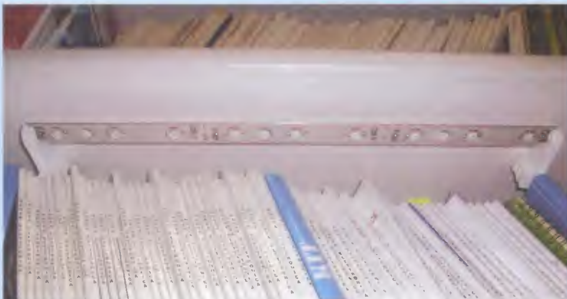
Fig.19 Per il fissaggio della barra luminosa potrete utilizzare gli stessi terminali plastici che vengono impiegati per il bloccaggio dei tubi al neon, e che potrete reperire facilmente in qualunque negozio di materiale elettrico. Se lo desiderate potete inserire la barra luminosa in un tubo in plexiglass, e in questo caso dovrete prevedere una serie di fori che garantiscano una buona aerazione.
