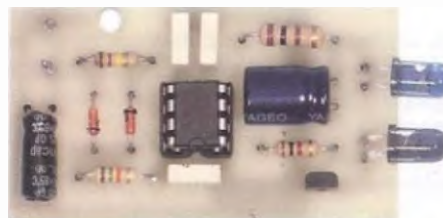
Fig.9 Foto dello stadio trasmettitore a montaggio concluso.
