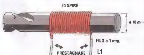
Fig.11 Per realizzare la bobina L1 destinata ad accogliere la resistenza R32, dovrete prendere del filo di rame smaltato da 1 mm ed avvolgere 20 spire intorno ad una punta da trapano del diametro di 10 mm.
