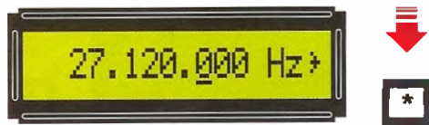
Fig.31 Poiché dovrete variare le centinaia di Hz, premete il tasto * fino a sottolineare il terzo 0 e poi il tasto con il segno - per scendere in frequenza (vedi figura successiva).
