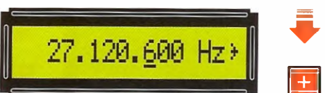
Fig.22 Premendo il tasto + quando raggiungerete il numero 27.120.600, il Tester indicherà un valore di tensione di circa 3 Volt (vedi Tabella N.2).
