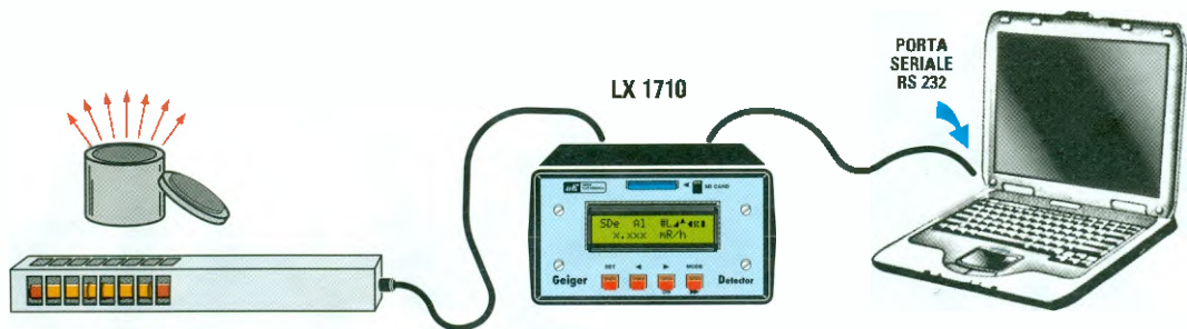
Fig.14 Prima di procedere all'interfacciamento del contatore con il personal computer dovrete verificare che il vostro pc sia dotato della presa di comunicazione seriale RS232. In caso contrario potrete effettuare ugualmente il collegamento tramite la porta USB del computer a patto di utilizzare un adattatore RS232 - USB come indicato in figura 12. In questo caso vi consigliamo di utilizzare adattatori di marche conosciute e di installare i driver seguendo attentamente le istruzioni riportate nel manuale di istruzioni allegato.
