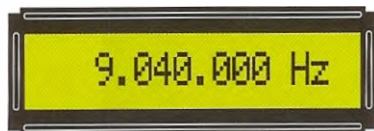
Fig.23 Per trovare la frequenza della risonanza SERIE di un quarzo da 27.120.000 in 3° armonica, dovete sempre digitare la frequenza fondamentale di 9.040.000 Hz.
