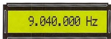
Fig.13 Poichè la frequenza Fondamentale di un quarzo da 27.120.000 Hz in 3° armonica è di 9.040.000 Hz, dovete digitare tale numero sulla tastiera.
