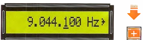
Fig.17 Raggiunto il numero 9.044.000, per ottenere una maggior precisione è necessario variare le centinaia di Hz, infatti l'esatta sintonia si ottiene sui 9.044.100 Hz.
