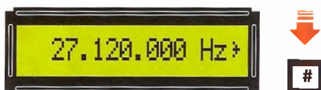
Fig.19 Dopo aver digitato il numero, premete il tasto # e subito vedrete apparire sulla destra di Hz il simbolo > che segnala che uscirà la frequenza richiesta.
