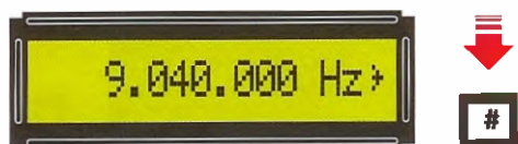
Fig.24 Digitato il numero 9.040.000, premete il tasto # e vedrete apparire sulla destra di Hz il simbolo > che segnala che dal BNC esce questa frequenza.
