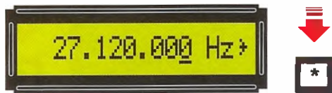
Fig.30 Ora premete il tasto * e, così facendo, verrà sottolineato il primo 0 a destra ad indicare che premendo il tasto - si modificherà la sola unità degli Hz.
