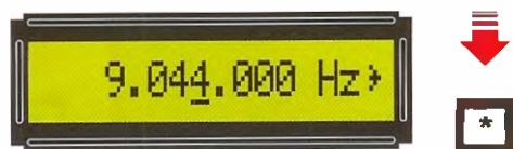
Fig.26 Come riportato nella Tabella N.2, poiché occorre variare le migliaia di Hz, premete il tasto * fino a posizionare il segno - sotto la quarta cifra.
