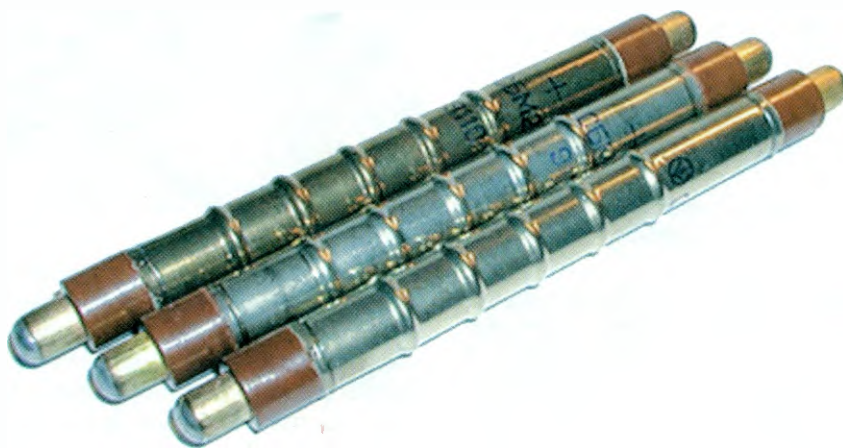
Fig.10 Abbassando la tensione di alimentazione da 500 a 400 Volt, è possibile utilizzare sul contatore anche il tubo SBM 20 di fabbricazione russa. A differenza del tubo LND 712 , l' SBM 20 misura unicamente radiazioni beta ad alta energia e radiazioni gamma , e presenta un conteggio di background più elevato.
