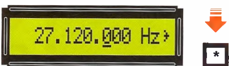
Fig.21 Come visibile nella Tabella N.2, poiché dovrete variare le sole centinaia di Hz, premete il tasto * fino a posizionare il segno – sotto il terzo 0 a partire da destra.
