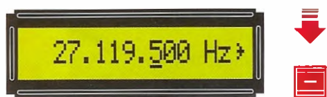
Fig.32 Premendo il tasto - quando raggiungerete il numero 27.119.500, il Tester vi indicherà un valore di tensione di circa 1,2 Volt (vedi Tabella N.2).
