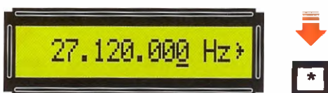
Fig.20 Ora premete il tasto * e così facendo verrà sottolineato il primo 0 a destra ad indicare che premendo il tasto + si modificherà la sola unità degli Hz.
