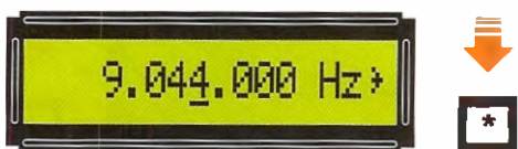
Fig.16 Come riportato nella Tabella N.2, poiché dovrete variare le migliaia di Hz, premete il tasto * fino a posizionare il segno – sotto la quarta cifra.
