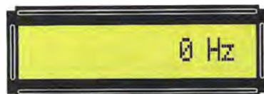
Fig.53 Per sottrarre il valore di MF accendete il circuito in modo che appaia 0 Hz .
