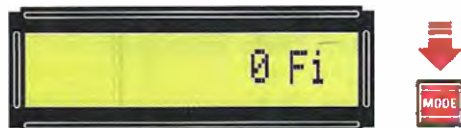
Fig.34 Dopo che sul display sarà apparso 0 Hz premete per "2 volte" il tasto Mode e vedrete apparire "Fi", cioè Frequenza Iniziale.
