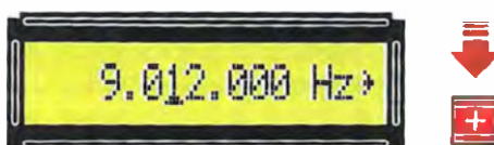
Fig.29 Arrivati a 9.009.000 Hz, se terrete premuto il tasto + la frequenza continuerà a salire. Se premerete il tasto - la frequenza invece scenderà.
