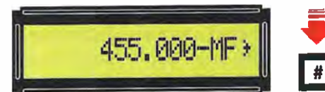
Fig.58 Premete il tasto # di conferma e sul display apparirà il relativo simbolo.
