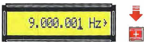
Fig.25 Premendo il tasto + la frequenza salirà di 1 Hertz. Utilizzando i tasti +/- per il cambio frequenza non sarà più necessario premere il tasto # di conferma.
