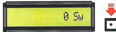
Fig.43 Per far avviare lo Sweep ripremete il tasto * e in questo modo vedrete apparire sul display la scritta "0 Sw".
