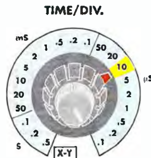
Fig.16 Se misurando un'onda Sinusoidale o qualsiasi altro tipo di onda, notate che questa copre 5 quadretti più "2 tacche" che hanno un valore di 0,4 (vedi fig.14), se la manopola del Time/div. risulta posizionata sulla portata dei 10 microsecondi, il valore di tale frequenza risulterà pari a: 1.000 : (10 \times 5,4) = 18,518 \text{ Kilohertz} .
