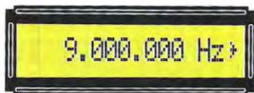
Fig.23 Impostato il Generatore in modo da ottenere sulla sua uscita una qualsiasi frequenza, potete variarla di pochi Hz-KHz-MHz utilizzando i tasti +/-.
