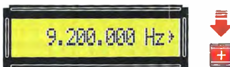
Fig.32 Premendo il tasto + la frequenza salirà sempre con salti da 100.000 Hz, cioè di 100 KHz. Premendo il tasto - la frequenza scenderà sempre di 100 KHz.
