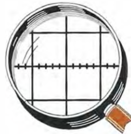
Fig.14 Ogni quadretto è suddiviso in orizzontale in "5 tacche" che vi serviranno per calcolare con maggiore precisione il valore di una frequenza, perchè come spiegato nel testo e indicato nella Tabella N.3, per ogni "tacca" va sommato un preciso valore.
