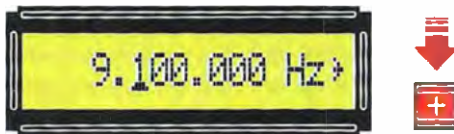
Fig.31 Come ormai vi sarà chiaro, premendo il tasto + la frequenza si incrementerà automaticamente di 100.000 Hz come evidenziato in figura.
