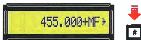
Fig.48 Digitate in Hz il valore della MF da sommare e premete il tasto # di conferma.
