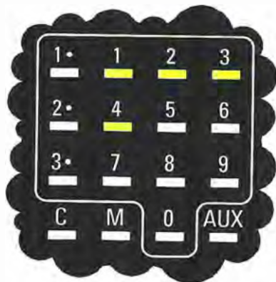
Fig.6 Per accitare e diseccitare i Relè1 e Relè 2 dovrete premere i tasti 1-2-3-4 che nel disegno appaiono di colore Giallo. Premendo il tasto 1, ecciterete il Relè 1, premendo il tasto 2 lo disecciterete. Premendo il tasto 3 ecciterete il Relè 2, premendo il tasto 4 lo disecciterete. A relè eccitato si accenderà il Diodo Led posto in parallelo alla bobina (vedi fig.4).
