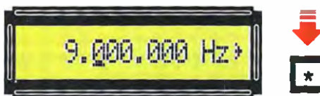
Fig.30 Per variare la frequenza di 100.000 Hz, dovrete premere il tasto * in modo da sottolineare il sesto 0 a partire da destra e poi procedere premendo il tasto +.
