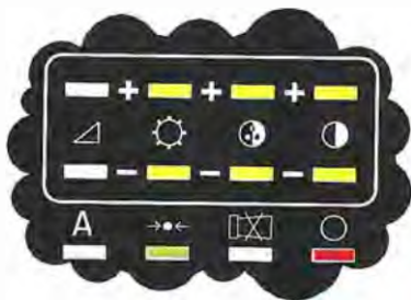
Fig.7 Per variare la luminosità delle lampade LP1-LP2-LP3 premete i tasti +/- che nel disegno appaiono di colore Giallo.
