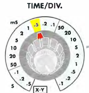
Fig.15 Se misurando un'onda notiamo che questa copre 4 quadretti più "3 tacche", che valgono 0,6 (vedi fig.14), con la manopola del Time/div. posizionata sugli 0,5 millisec., il valore di questa frequenza risulterà esattamente pari a: 1.000 : (0,5 \times 4,6) = 434,78 \text{ Hertz} .
