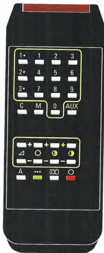
Fig.2 Prospetto del telecomando a raggi infrarossi utilizzato per il Light Controller. Poiché il telecomando è sprovvisto di pila da 9 Volt, dovrete provvedere voi ad inserirla nell'apposito vano aprendo lo sportellino posto sul retro.
