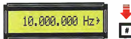
Fig.54 Di seguito dovrete inserire il valore della Frequenza da ottenere - la MF .
