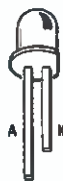
Fig.2 Ricordatevi che nei diodi led il terminale più lungo è l'Anodo e quello più corto il Katodo.
