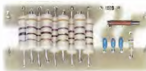
Fig.1 Foto della Sonda di Carico RF che riesce ad accettare sul suo ingresso una potenza massima di circa 15 Watt. Come potete notare, le 9 resistenze da 470 ohm 2 Watt risultano disposte su due strati per evitare di dover realizzare un lungo e stretto circuito stampato.
