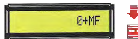
Fig.55 Premete "1 sola" volta il tasto Mode e sul display apparirà 0+MF .
