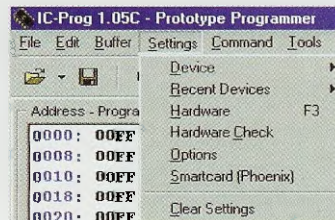
Fig.29 Per configurare le Opzioni fornite dal programma, cliccate sul menu Settings e poi sulla scritta Options . Dopo aver configurato il programma in italiano (vedi fig.30), il menu si chiamerà Settaggi .
