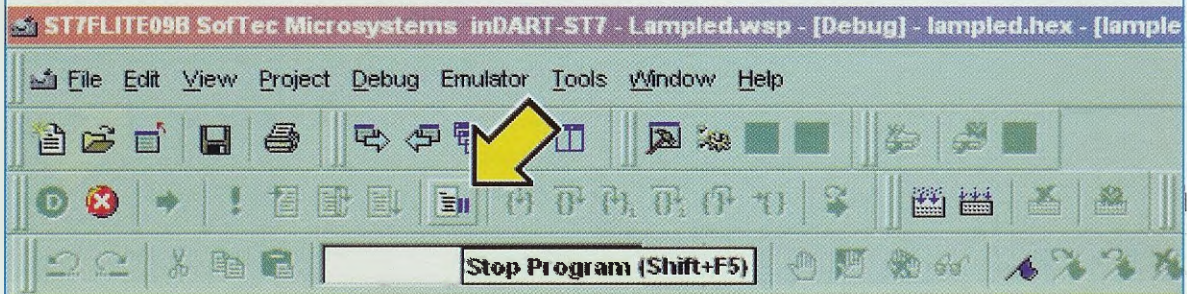
Fig.28 Se dopo aver attivato il programma volete "bloccarlo", dovrete cliccare sull'icona indicata dalla freccia e non vedrete più lampeggiare il diodo Led.
