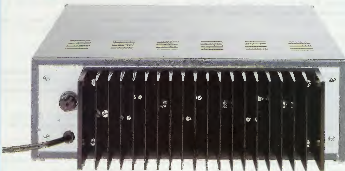
Fig.14 L'aletta di raffreddamento viene direttamente fissata sul pannello posteriore del mobile. Durante il funzionamento conviene tenere questa aletta leggermente distanziata dal muro, per permettere all'aria di circolare e raffreddarla. Non preoccupatevi se la temperatura dell'aletta raggiunge i 40-50 gradi centigradi, perché è assolutamente normale.
