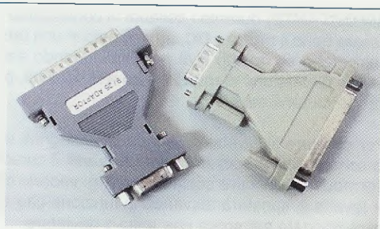
Fig.18 Se nel vostro computer l'uscita RS.232 è a 9 poli anziché a 25 poli, dovete procurarvi un comune adattatore che potete trovare in un qualsiasi negozio di PC.
