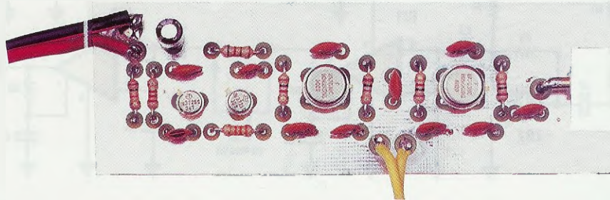
Fig.10 Il piccolo circuito stampato siglato CS.1552 è un doppia faccia con i fori metallizzati. Lo strato di rame prestagnato, visibile sulla parte superiore del circuito, serve da schermo per le piste presenti sulla superficie inferiore. Sul circuito stampato che invieremo assieme al kit, troverete riportato un disegno serigrafico completo di sigle dei singoli componenti e della vernice antiossidante depositata su entrambi i lati.
