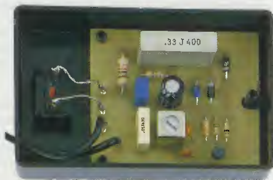
Fig.1 Foto dello stadio trasmittente già inserito all'interno del suo mobile plastico. Per evitare che tirando il cordone di rete i suoi fili si possano distaccare dai due terminali posti sul circuito stampato, consigliamo di fare un nodo sul cordone (vedi fig.6).
