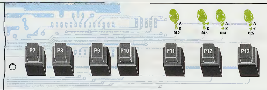
Fig.17 Dal lato opposto di questo stampato dovrete inserire i 5 display e i 13 pulsanti. Il terminale più lungo dei diodi led (vedi A) va rivolto verso l'alto.
