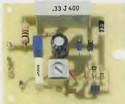
Fig.7 Foto della basetta dello stadio trasmettente con sopra già montati tutti i suoi componenti. Si noti vicino a DS1 il piccolo diodo zener DZ1.
