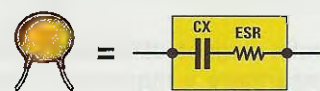
Fig.417 Ricordatevi che ogni condensatore ha una sua resistenza teorica, ESR , che varia al variare della frequenza di lavoro.
