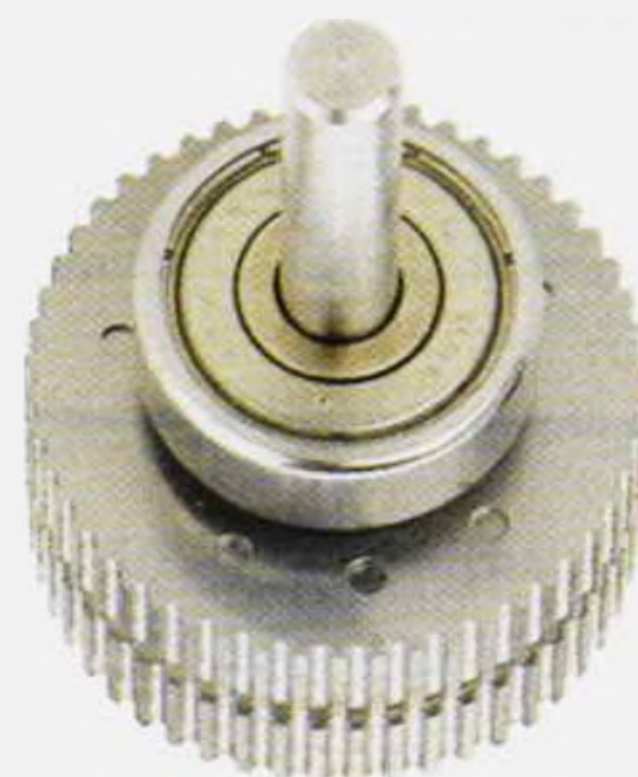
Fig.2 Sul perno motore è collocato un cilindro provvisto di due file di denti magnetizzati che si posizioneranno in corrispondenza delle bobine eccitrici.
