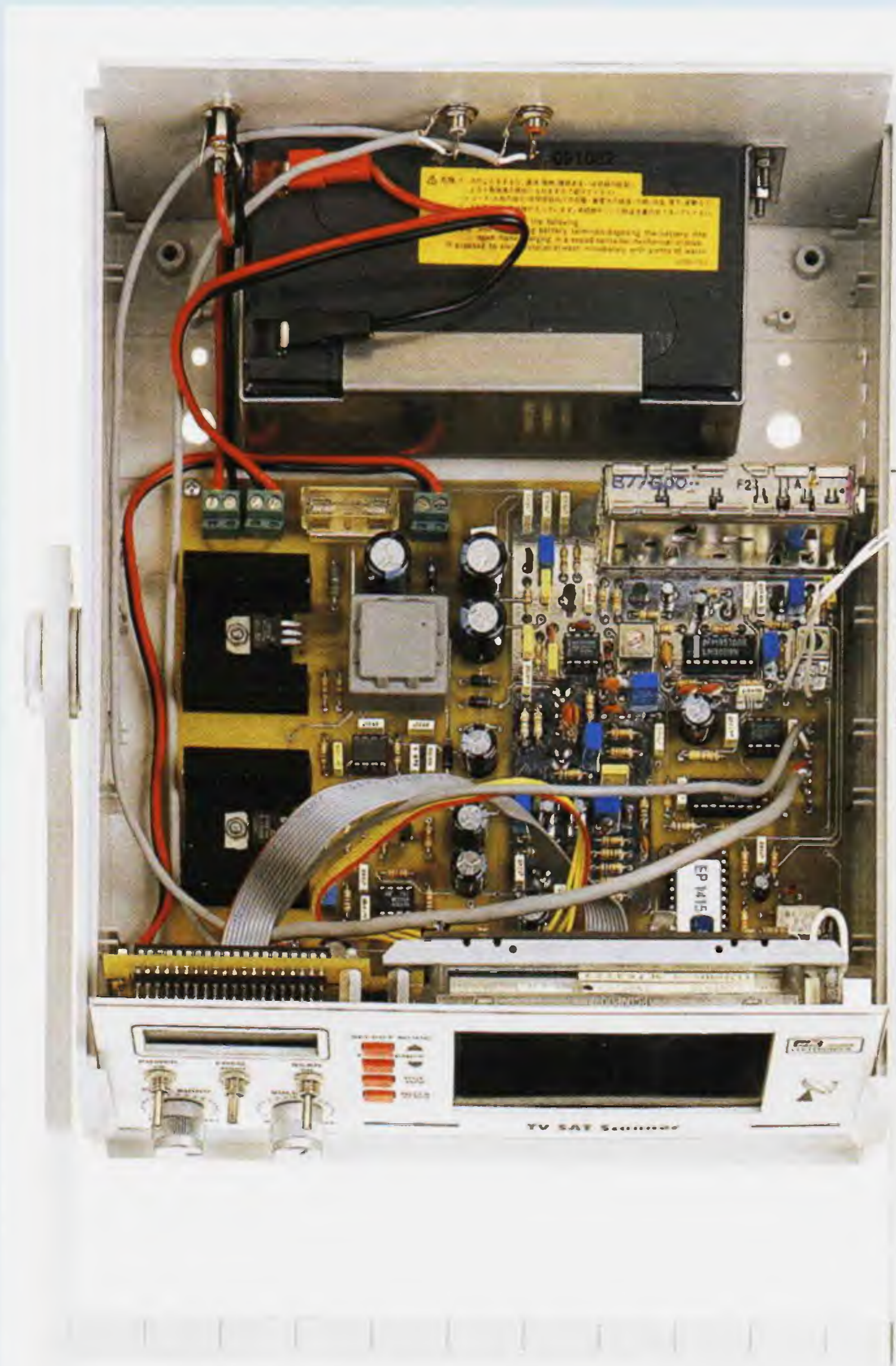
Fig.19 Sul piano del mobile fissate lo stampato LX.1415 e sul pannello frontale lo stampato del display LCD e del monitor LCD a colori. La batteria di alimentazione va fissata sul pannello posteriore, usando la squadretta metallica che troverete all'interno del blister.
