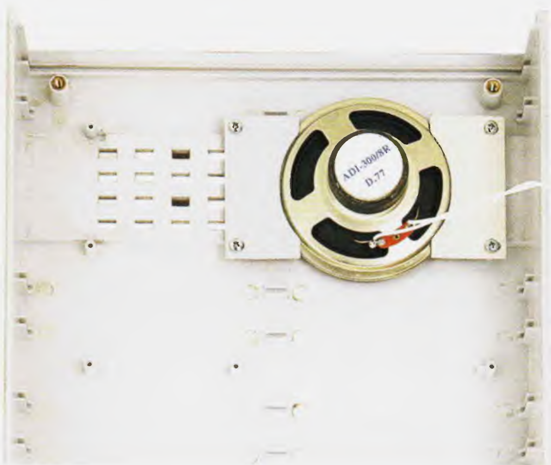
Fig.20 Il piccolo altoparlante va fissato sul coperchio superiore del mobile per mezzo di due squadrette sagomate.
