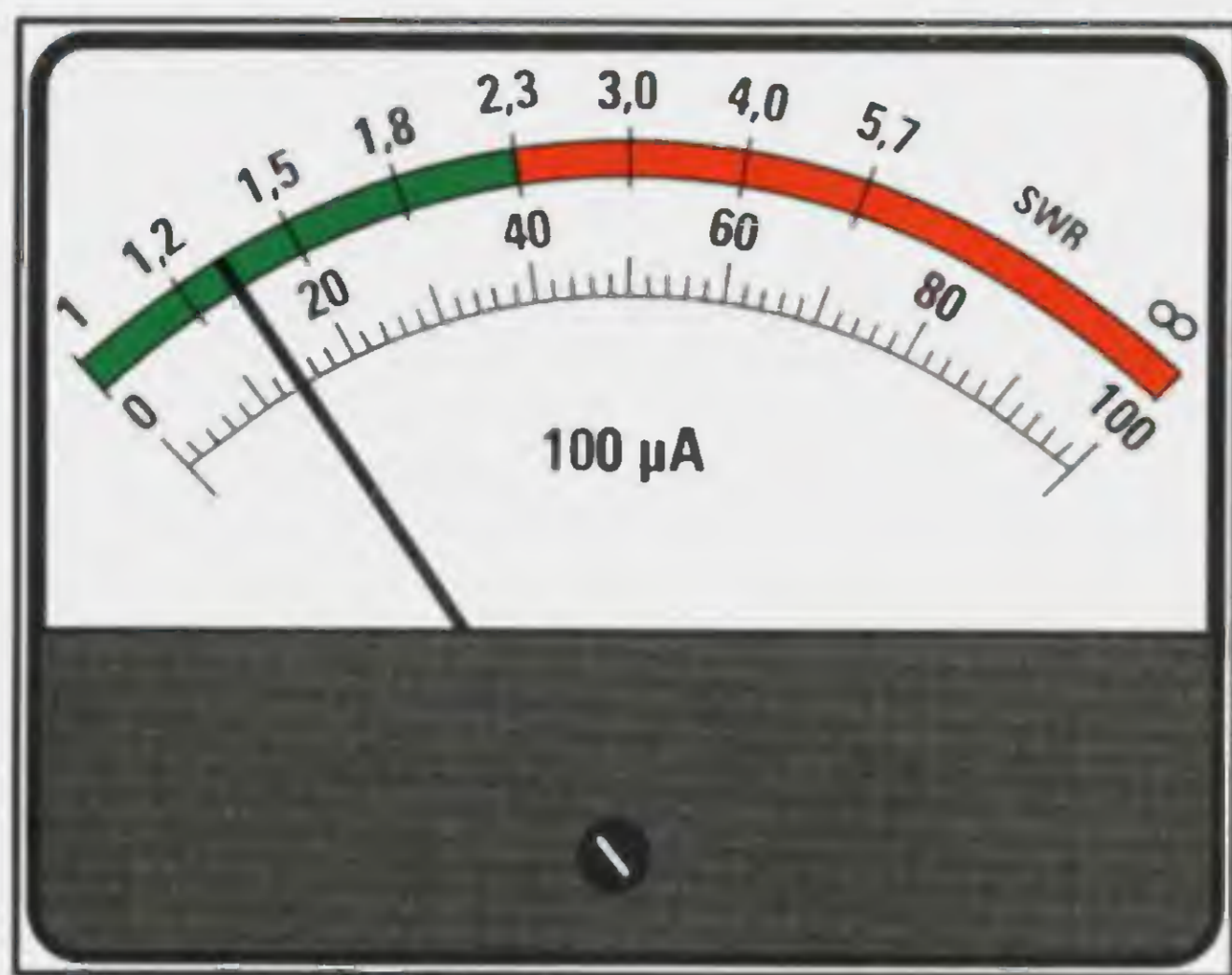
Fig.11 Se il tester risulta commutato sulla portata 100 microamper, dopo aver spostato la leva del deviatore S1 sull'onda diretta e ruotato il potenziometro R3 in modo da portare la lancetta sul fondo scala, spostate la leva del deviatore S1 sull'onda riflessa. Leggendo il valore dei microamper dell'onda riflessa potete conoscere, con l'aiuto della Tabella qui sotto riportata, il rapporto delle Onde Stazionarie ed anche il rendimento dell'antenna.
