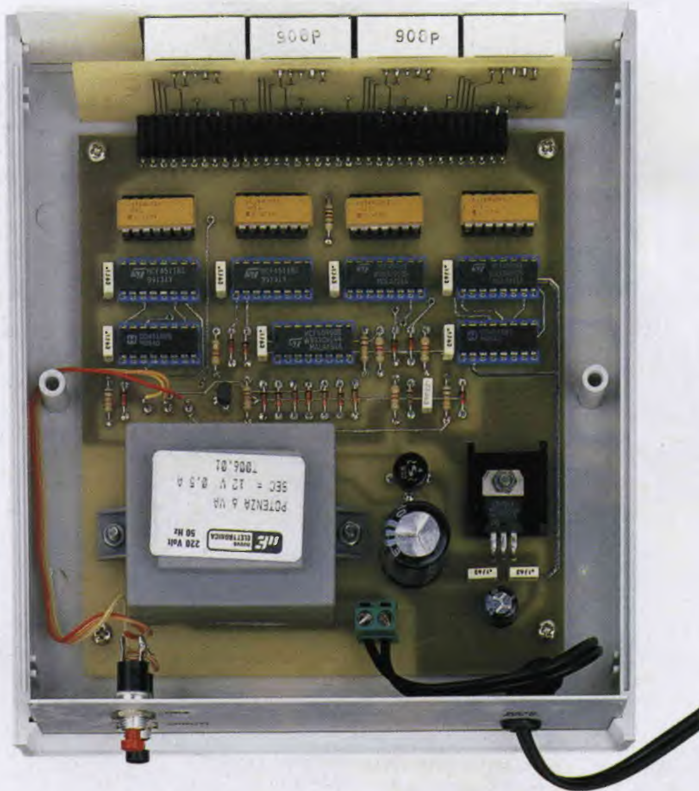
Fig.282 Dopo aver inserito il connettore femmina presente sullo stampato LX.5035/B sul connettore maschio presente sullo stampato LX.5035 potrete fissare il tutto all'interno dell'elegante mobile che vi verrà fornito su richiesta.
