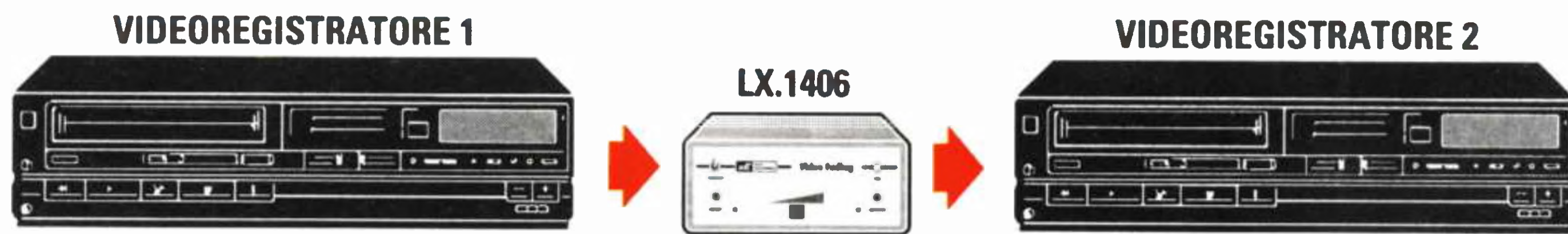
Fig.12 Per miscelare due immagini occorrono due Videoregistratori. Nel primo dovete inserire la cassetta dalla quale desiderate prelevare le varie immagini, nel secondo la cassetta nella quale volete inserire tali immagini con la dissolvenza.
