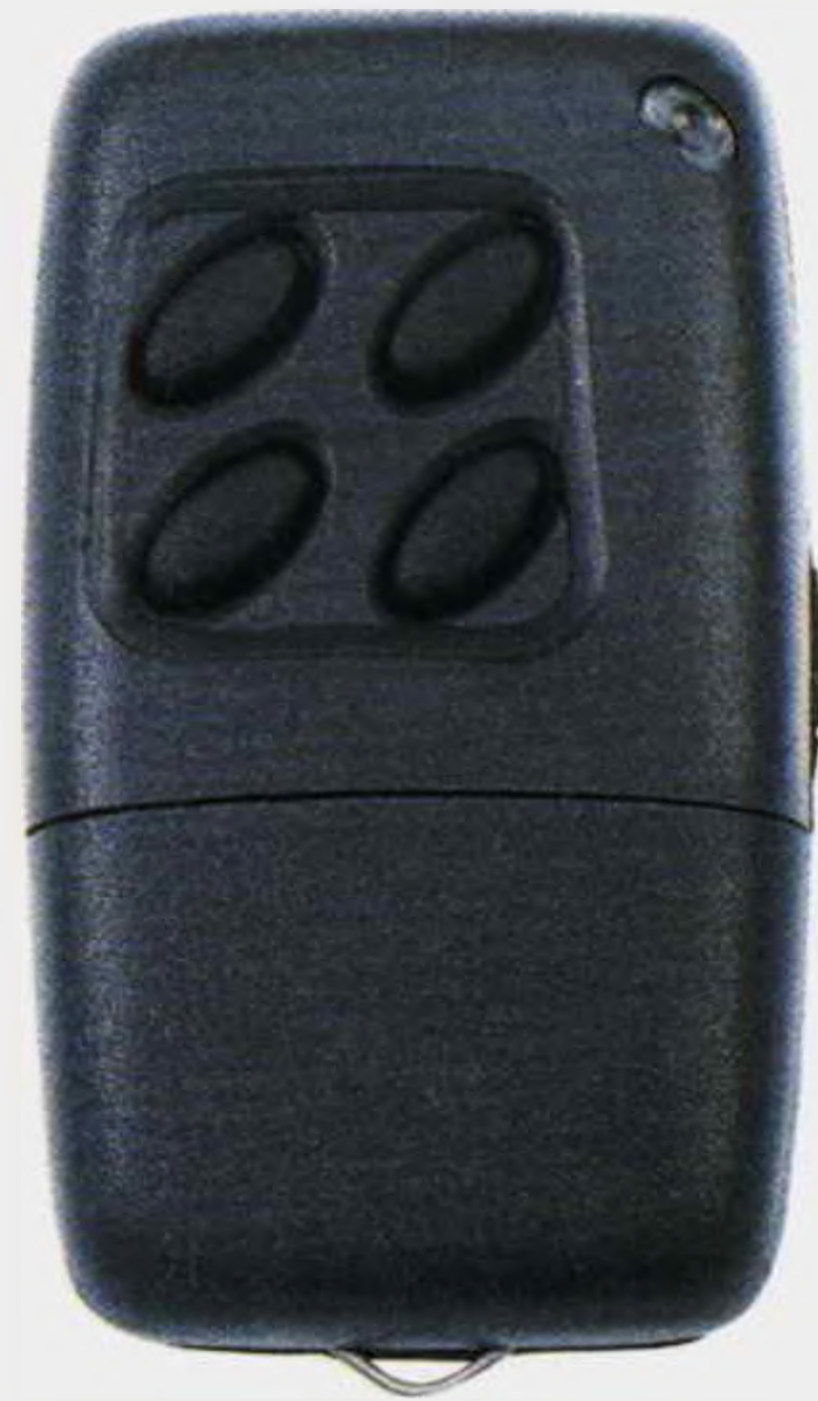
Fig.18 Foto del piccolo trasmettitore tascabile. Ogni volta che premerete un pulsante si accenderà il piccolo led posto in alto a destra.
