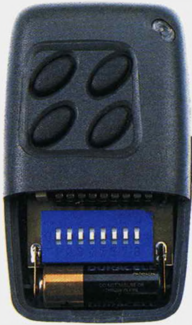
Fig.17 Il coperchio del mobile è suddiviso in due parti così da poter accedere agevolmente alla pila per sostituirla quando è scarica.
