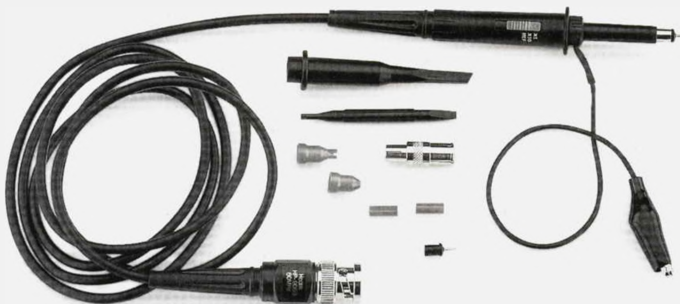
Fig.25 Come abbiamo spiegato negli articoli precedenti, sull'ingresso della sonda non dovete mai applicare dei segnali che superano i 40 volt picco/picco (20 volt positivi e 20 negativi). Inserendo nell'ingresso il puntale sonda KM01.31 potrete arrivare ad un massimo di 400 volt picco/picco perché provvisto di due attenuatori X1 e X10 . Questa sonda completa di tutti gli accessori visibili nella foto, può essere usata anche per oscilloscopi o altri strumenti di misura. Costo del puntale L.62.000 (abbonati L.55.800 ).
