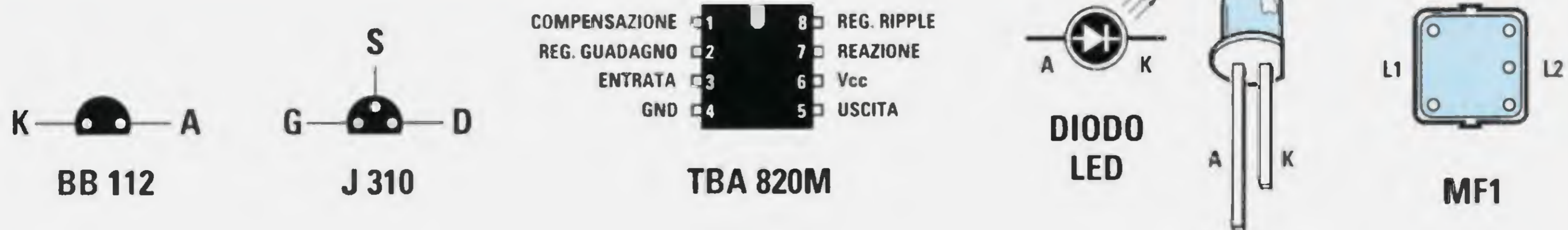
Fig.353 Connessioni dei terminali dei diodi varicap BB.112, del fet J.310 e della Media Frequenza MF1 viste da sotto. Le connessioni del solo integrato TBA.820/M sono viste da sopra. Ricordate che il terminale più lungo del diodo DL1 è l'A ed il più corto il K.
