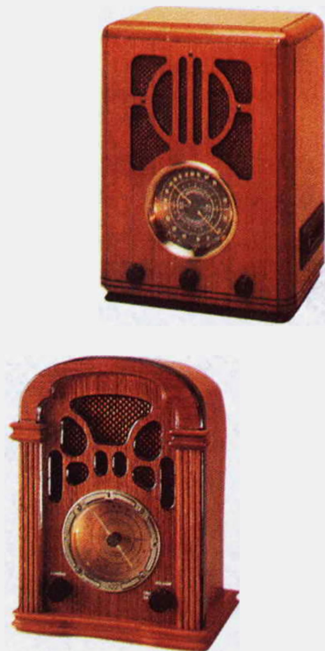
Fig.315 Le prime radio (1930-1938) potevano ricevere le sole emittenti che trasmettevano in AM sulle onde Lunghissime e Medie. Tutte queste vecchie radio avevano bisogno di una lunga antenna e di una buona presa di terra.
