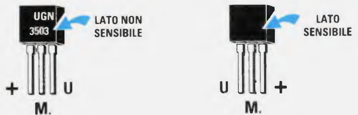
Fig.5 Connessioni dei tre terminali + M U del sensore di Hall viste dal lato della sigla e dal lato opposto. Il lato da passare sulla scheda è quello di destra.
