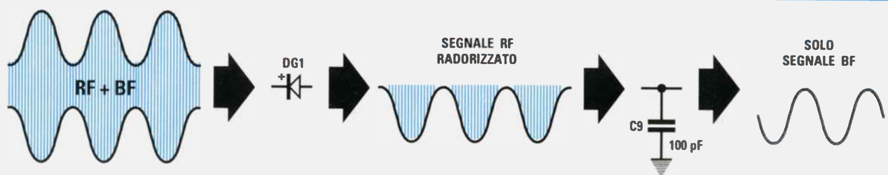
Fig.354 Un segnale RF modulato in ampiezza presenta sempre sovrapposto sulle due estremità superiore ed inferiore il segnale di BF. Questo segnale applicato sull'ingresso del diodo DG1 lascerà passare le sole "semionde negative" compreso il segnale BF ad esse sovrapposto. Il condensatore C9 da 100 pF collegato tra l'uscita del diodo DG1 e la massa (vedi fig.352) eliminerà il segnale RF ma non il segnale di BF.
