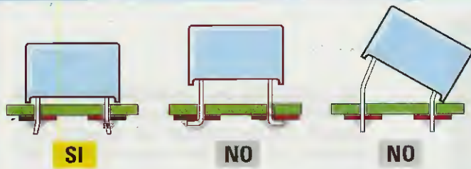
Fig.157 Il corpo di un condensatore va sempre appoggiato sul circuito stampato. Se collocate il condensatore sollevato o con il corpo inclinato da un lato otterrete un circuito esteticamente poco presentabile.
