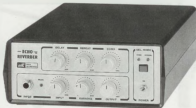
Fig.7 Come si presenta il pannello frontale di questo kit. I tre potenziometri posti in alto servono per variare i tempi dell'Eco - Repeat - Delay e quelli in basso per dosare i Volumi (vedi fig.8).
