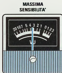
Fig.5 La massima sensibilità si ottiene portando la lancetta dello strumento all'incirca a metà scala, cioè prima che la cicalina suoni.
