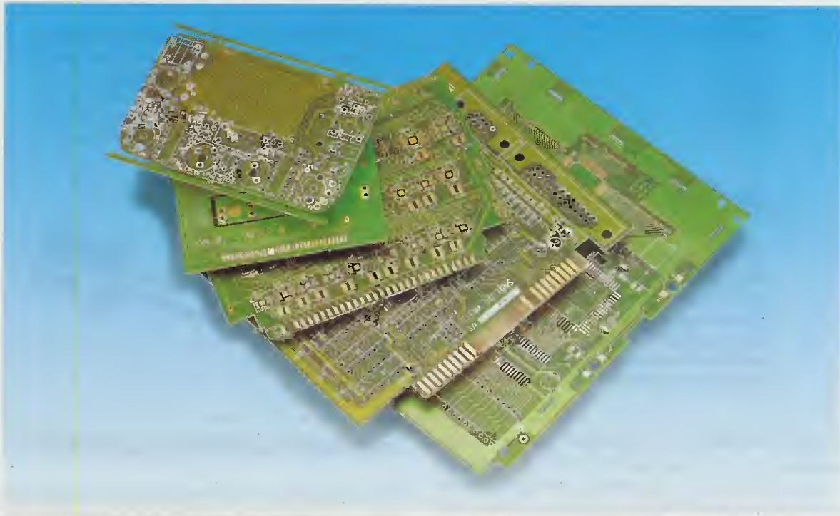
Fig.139 Per realizzare un progetto tutti i componenti vengono oggi montati su un circuito stampato, cioè su una basetta di vetronite con tante piste in rame che nel loro percorso collegano i vari componenti come lo richiede lo schema elettrico. I circuiti stampati possono essere a monofaccia o a doppiafaccia (vedi figg.151 - 152).
