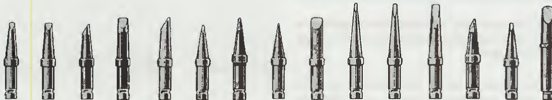
Fig.145 Tutti i saldatori professionali, cioè quelli più costosi, sono dotati di una serie di punte intercambiabili che possono avere forme diverse. Le punte sottili vengono adoperate per stagnare terminali molto ravvicinati, le punte medie per normali stagnature e le punte più larghe per stagnare superfici che potrebbero raffreddare una punta sottile.
