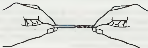
Fig.149 Prima di stagnare i sottilissimi fili flessibili, presenti in un cavetto ricoperto in plastica, vi conviene sempre attorcigliarli per evitare che si sfilaccino.
