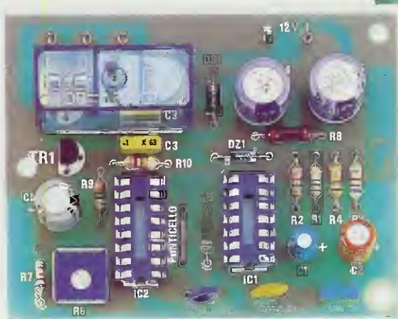
Fig.166 Se le vostre stagnature assomigliano a quelle visibili in questa foto, difficilmente i vostri circuiti riusciranno a funzionare. In questo caso le dovrete rifare.
