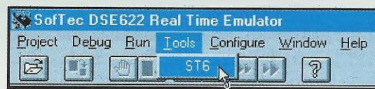
Fig.92 Per entrare nell'editor dell' ST6 dal DSE, scegliete ST6 dal menu Tools .
