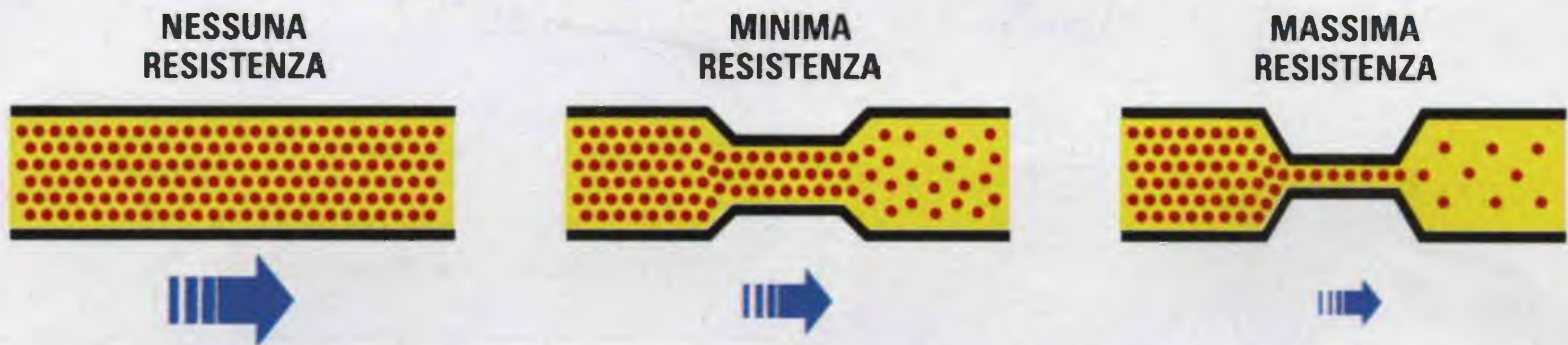
Fig.44 Possiamo paragonare una "resistenza" ad una strozzatura posta in serie ad un conduttore per ridurre il regolare flusso di elettroni. Una resistenza con un "basso" valore ohmico (media strozzatura) ridurrà molto meno il flusso degli elettroni rispetto ad una resistenza con un "elevato" valore ohmico (strozzatura maggiore).
