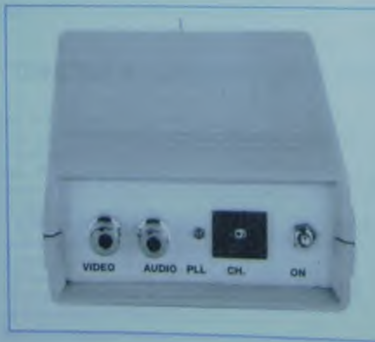
Fig.1 Sul pannello frontale del mobile sono presenti le due bocche d'ingresso per il segnale Audio-Video ed un commutatore binario per la scelta del Canale di trasmissione (vedi Tabella a pag.70). Come visibile nella foto di destra, questo progetto viene fornito completo di una piccola antenna a stilo.
