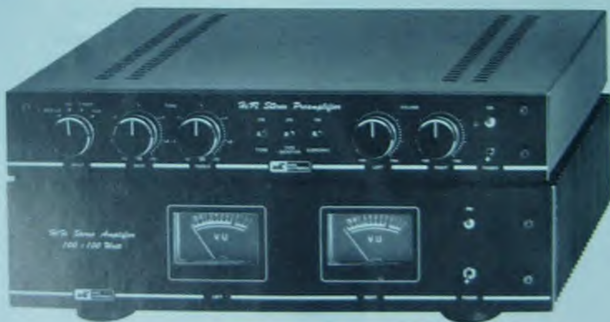
Fig.1 In questa foto potete vedere come si presenta un completo impianto Hi-Fi composto dal preamplificatore tutto a Fet, presentato sulla rivista N.169/170, e dall'amplificatore IGBT. Le due alette di raffreddamento per gli IGBT risultano fissate ai due lati del mobile metallico.
