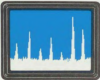
Fig.434 Se colleghiamo il Misuratore di Campo sull'uscita della Centralina senza aver tarato nessun Filtro, noteremo quanto risultano diverse le ampiezze dei segnali captati.
