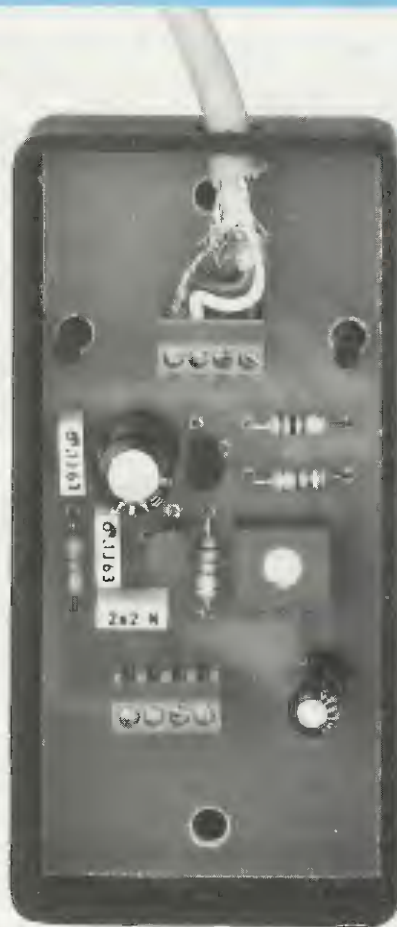
Fig.5 In alto a sinistra lo schema pratico di montaggio dello stadio oscillatore LX.1045/B. Sulla morsettiere posta in basso, collegheremo il cavetto schermato proveniente dalla testa captatrice, cercando di inserire al "centro" il filo di color BIANCO. Dalla morsettiere posta in alto partirà il cavetto schermato che si collegherà al circuito visibile in fig.9.
