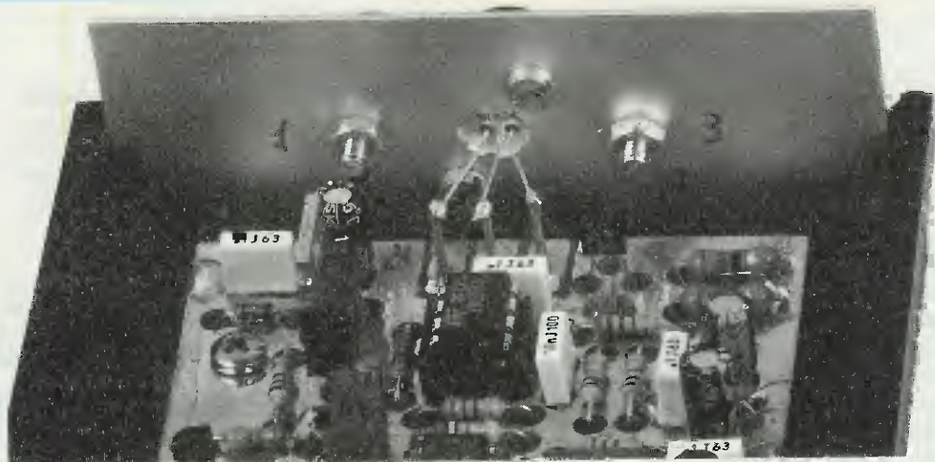
Fig.18 Per stagnare i tre terminali del Diodo Laser sulle piste 1-2-3 presenti sul circuito stampato, dovrete ripiegarli leggermente, come visibile in fig.8, oppure stagnarli su tre corti spezzoni di filo di rame che avrete in precedenza saldato sulle piste dello stampato.
