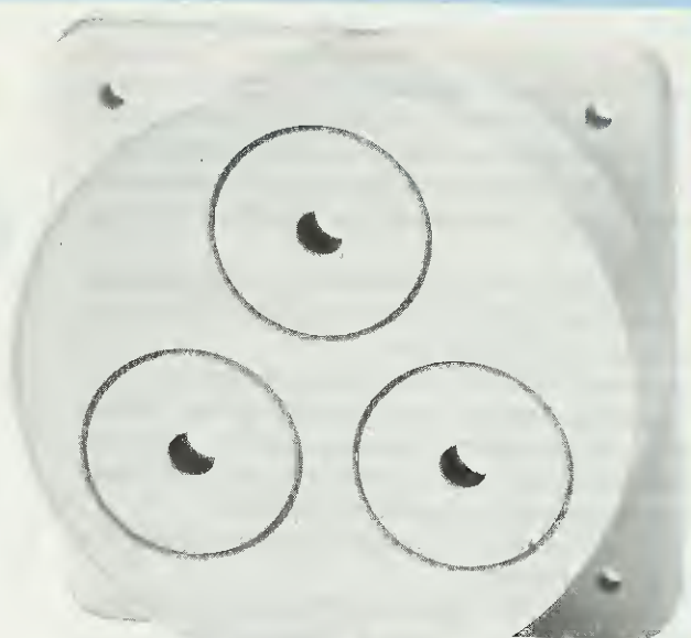
Fig.7 Foto della minuscola ma potente Sirena per antifurto. Questa Sirena che assorbe soltanto 300 milliamper, a 12 Volt, è in grado di erogare una potenza sonora di ben 115 decibels.
