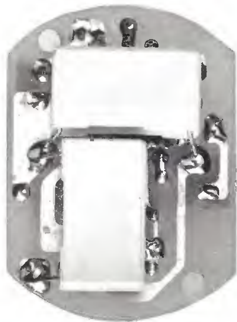
Fig. 8 I due condensatori C3-C5 da 100.000 pF 630 Volt lavoro, andranno applicati sul retro dello stampato e i loro terminali, direttamente saldati sulle piste in rame.
