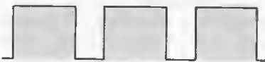
Fig.4 Se il tempo in cui il transistor rimane chiuso (conduzione), è maggiore del tempo in cui rimane aperto (duty cycle 60%), sull'uscita vi ritroverete una tensione più elevata.
