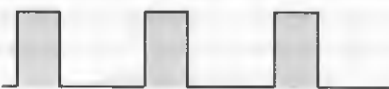
Fig.5 Se il tempo in cui il transistor rimane chiuso risulta minore del tempo in cui rimane aperto (duty cycle 40%), sull'uscita vi ritroverete una tensione minore del 50%.
