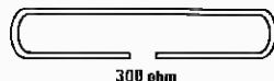
Fig. 48 Se il dipolo risulta «ripiegato» come vedesi in figura, l'impedenza caratteristica aumenta di 4 volte, pertanto sul punto di prelievo non vi saranno più 75 ohm bensì 75 \times 4 = 300 ohm.
