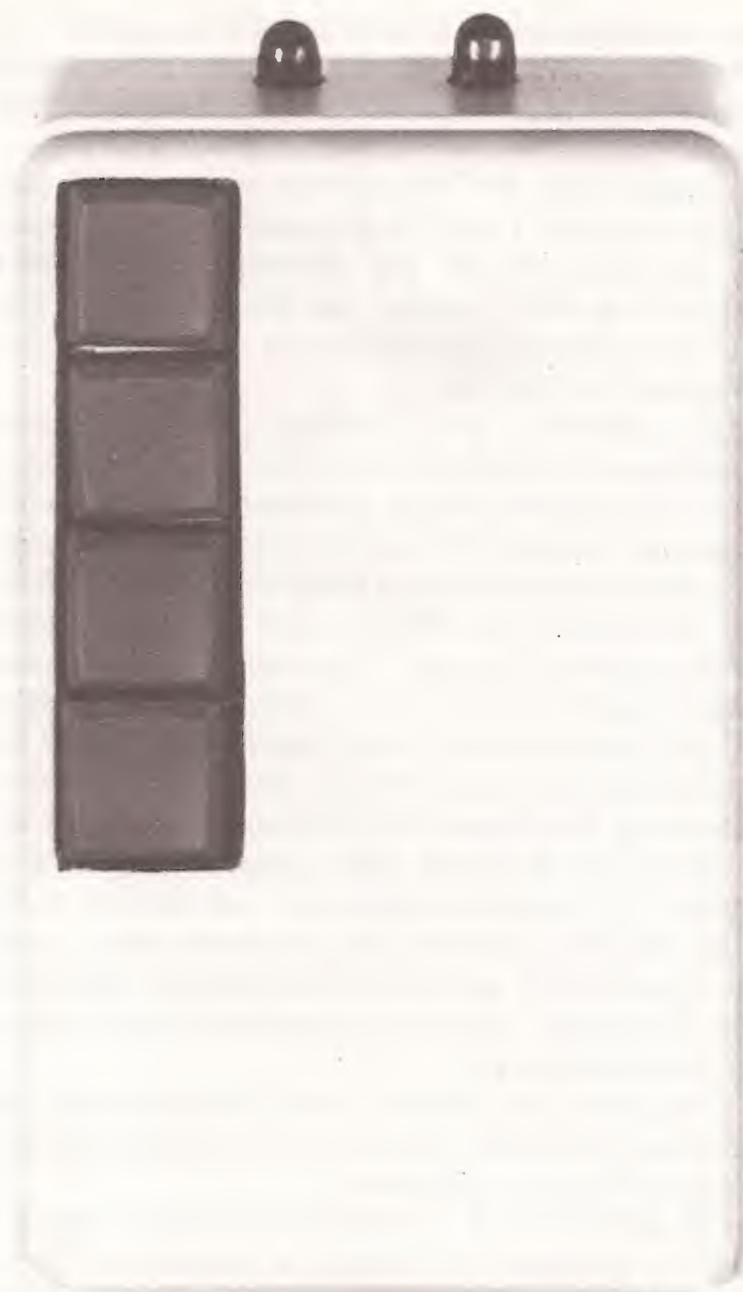
Fig.11 Per far invece fuoriuscire i quattro pulsanti di comando dalla scatola, dovrete praticare su quest'ultima un'asola rettangolare servendovi di una sottile punta da trapano. Il perimetro verrà poi rifinito.
