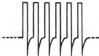
Fig. 3/B Anche variando la frequenza, affinché l'elettro agopuntura risulti efficace, la semionda negativa deve assumere la stessa forma che abbiamo disegnato in fig. 2. Questa forma d'onda viene comunemente chiamata dai medici «onda cinese».
