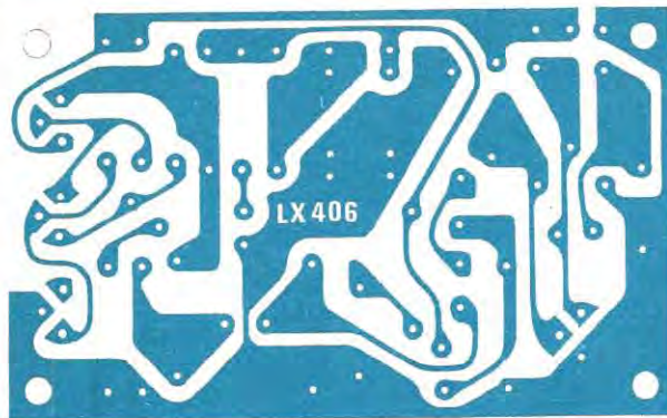
Fig. 2 Disegno a grandezza naturale del circuito stampato.
