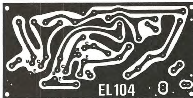
Fig. 2 Circuito stampato a grandezza naturale del distortore per chitarra elettrica mod. EL.104.
