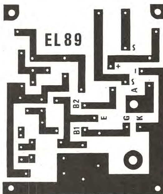
Fig. 2 Circuito stampato a grandezza naturale del progetto EL89.
