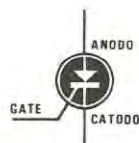
Fig. 2 Un diodo SCR dispone, oltre ai due terminali catodo e anodo di un terzo denominato « gate » (terminale di eccitazione o porta). Simbolicamente negli schemi elettrici viene raffigurato come nel disegno.
