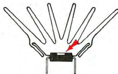
Fig. 3. Nel collegare l'integrato sul circuito stampato, fate attenzione all'incavo presente solo su un estremo del corpo, per non confondere i terminali 1-16 e l'8 e il 9.
