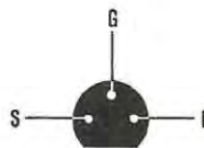
Fig. 3. I terminali D - S - G risultano disposti come vedesi in figura.
