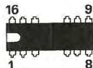
Fig. 4. Se non fosse presente l'aletta di raffreddamento (visto quindi di sopra) la disposizione dei terminali risulterebbe come indicato in figura.
