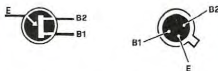
Fig. 4. Rappresentazione grafica dei transistor unigiunzione e disposizione dei relativi terminali nello zoccolo.
