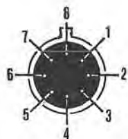
Fig. 7 Disposizione dei terminali dell'uA.709. In questa figura sono visibili dal lato in cui fuoriescono dallo zoccolo.
