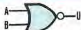
Fig. 3 La logica tipo OR si trova normalmente accoppiata con un INVERTER in uscita. Poiché questa è anche la più comunemente impiegata, essa viene denominata logica NOR per non dover sempre indicare OR con INVERTER sull'uscita.
