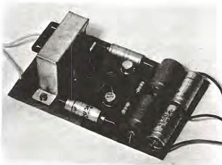
In questa foto vi presentiamo lo stadio alimentatore da noi impiegato per il capacimetro descritto in questo articolo.
