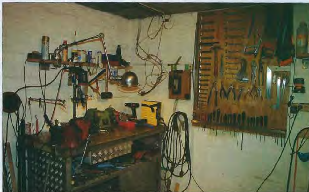
Vue partielle de l'atelier de l'auteur. La structure de l'établi est en cornières inox, ainsi que la visserie d'assemblage, le reste en plaques d'aluminium, le tout est facilement démontable.
