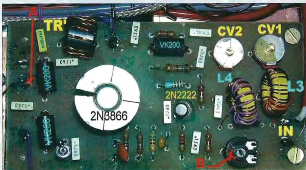
Photo 10 (6) - Driver Bingo 20 V3. A : Sortie vers PA. B : Dans la version 3, la résistance ajustable est supprimée.
