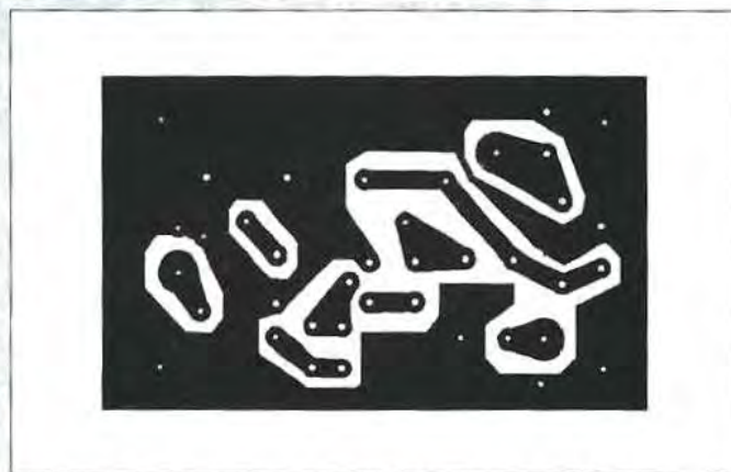
Figure 8 - Ampli HF réception : Circuit imprimé 65 x 40.
