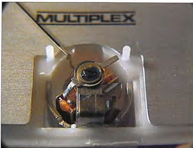
1 - Le cœur d'un galvanomètre à cadre mobile.
