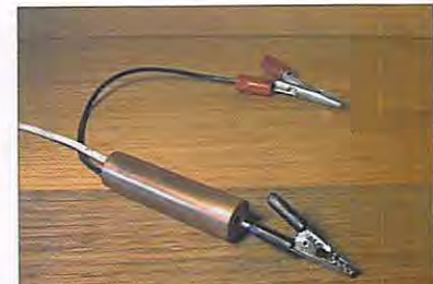
8 - Une sonde HF fabrication maison.
