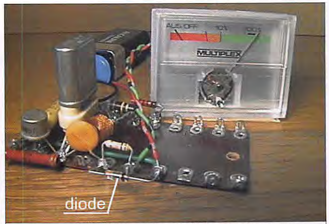
7 - L'oscillateur HF - contrôleur de quartz.
