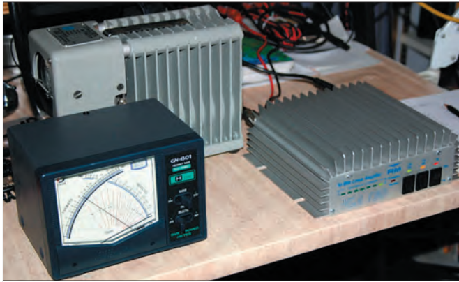
3 - Lors des mesures de puissance, 65 W sous 12,5 V pour 5 W d'entrée.
