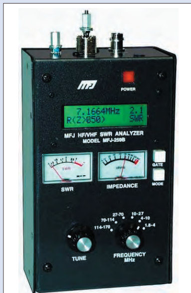
3 – Analyseur d'antenne : l'un des plus connus, le MFJ-259B.
