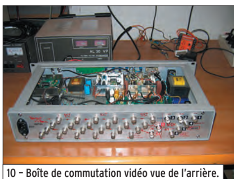
10 - Boîte de commutation vidéo vue de l'arrière.
